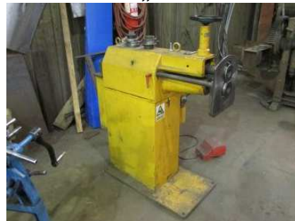
Ad 37 Valjci za kružno sav. lima-ručni pogon
